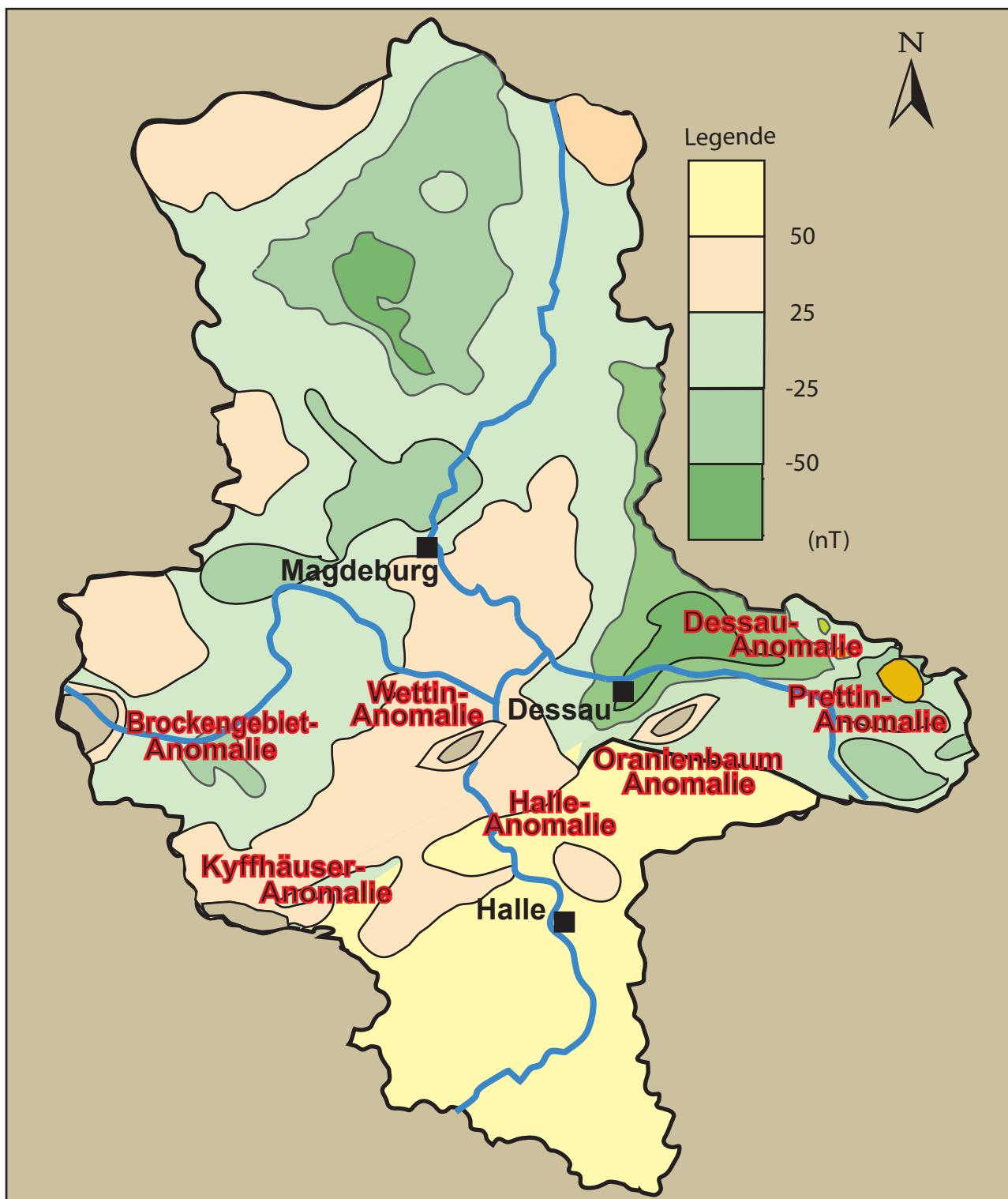
Abb. 30.13.4 Geomagnetische Übersichtskarte von Sachsen-Anhalt
