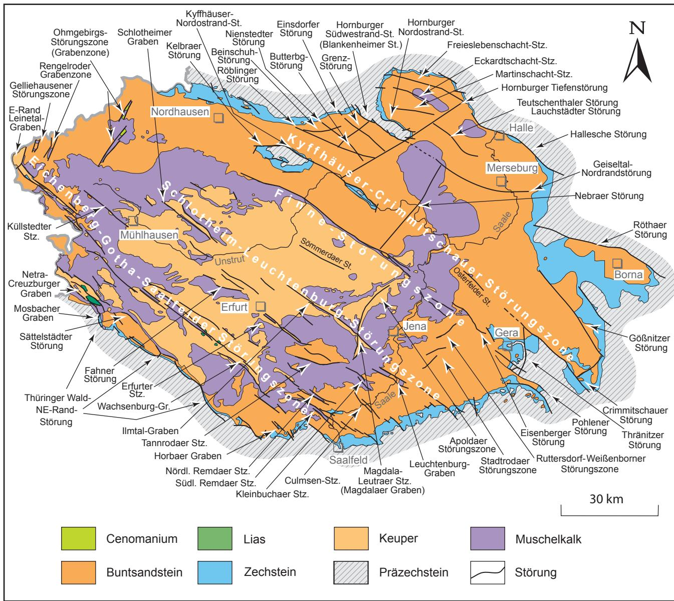
Abb. 32.3 Saxonische Bruchstörungen im Bereich des Thüringer Beckens *sensu lato* (Auswahl)
